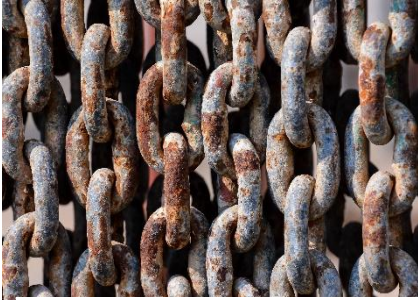
Demirin oksijen gazı ile tepkimesi sonucunda pas oluşur.
